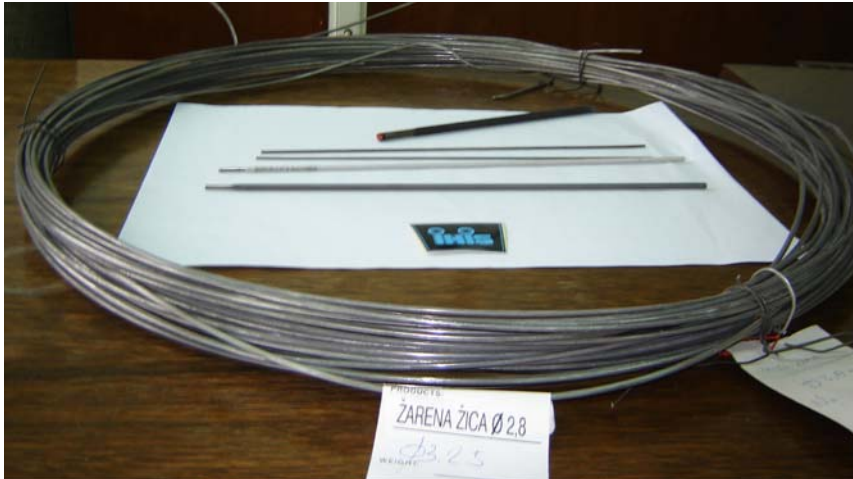
Слика 3. Изглед пуњене жице пречник 3,25 мм добијене вишестепеним извлачењем
