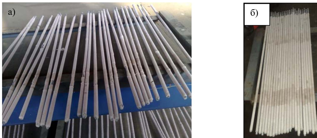
Слика 7 (а,б). Обложене електроде добијене облагањем пуњене шипке
