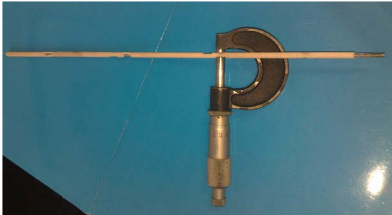
Слика 8. Мерење микрометром ексцентричности дебљине облоге електроде
