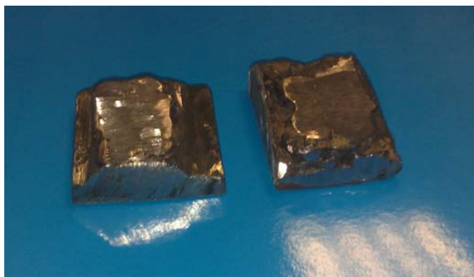
Слика 9. Наварени узорци са више пролаза намењени за испитивање хемијског састава шава
